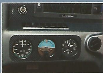
Velocímetro, horizonte artificial e altímetro analógicos para o caso de falha no EFIS
