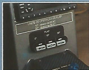
No detalhe, temos os indicadores de posição dos flaps da nossa máquina
