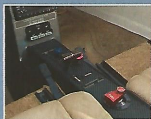
Console de manetes e indicadores de posição dos flaps e seletora de combustível
