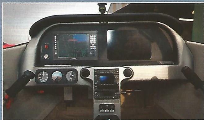
Painel EFIS – MGL Odyssey com telas de 10 polegadas, console de rádios e detalhe dos sidesticks na lateral
