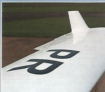
Detalhe dos winglets recuados do bellissimo Volato 400
